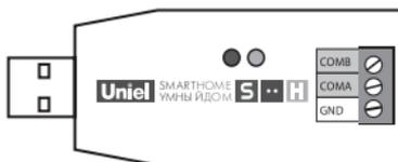
Порты COMA и COMB подключаются к соответствующим портам в модуле. Подключение нейтрали GND производится через один из четырех терминалов для подключения нейтрали по входу. Далее преобразователь подключается к компьютеру через USB порт.
