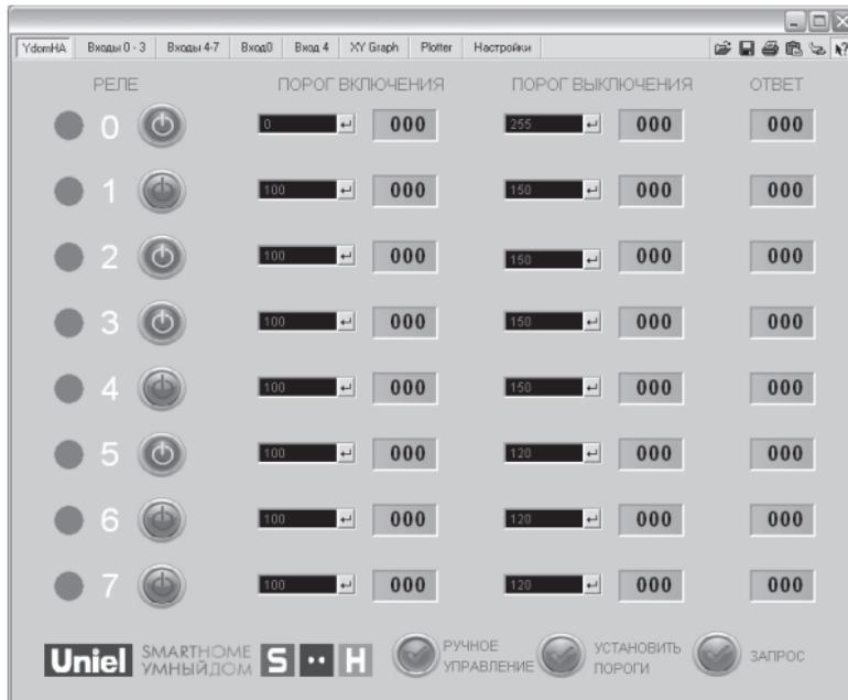
В верхнем правом углу окна программы располагается меню функций: загрузить предустановки, сохранить установки, распечатать и копировать, установка адреса порта (иконка в виде сетевой вилки).
