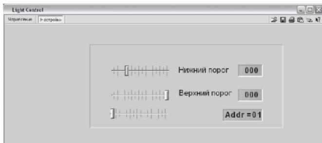
и переместите ползунок «Addr» в положение 1 (по умолчанию адрес модуля – «1»). Если связь модуля с компьютером не наблюдается (индикатор «TALK» не мигает), установите следующий адрес (2, 3, 4 и т. д.). Индикатор «TALK» должен мигать 10 раз в секунду.
