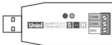
Порты COMA и COMB подключаются к соответствующим портам в модуле. Подключение нейтрали GND производится через один из четырех терминалов
