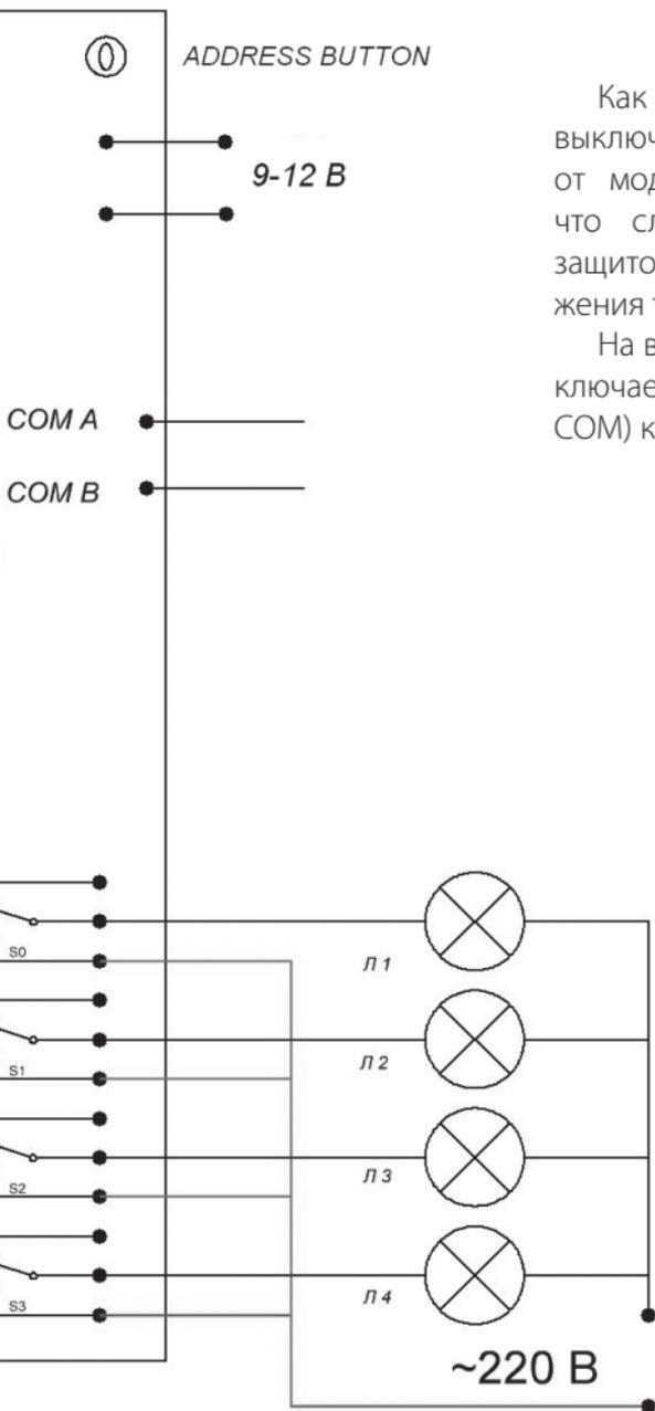
Как видно из данной схемы, выключатели питаются только от модуля напряжением 5 В, что служит дополнительной защитой от случайного поражения током при 220 В.
