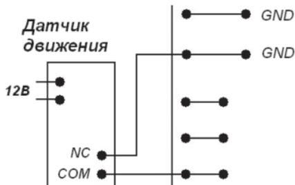
Для данного модуля подходят только датчики движения с «сухим контактом».
