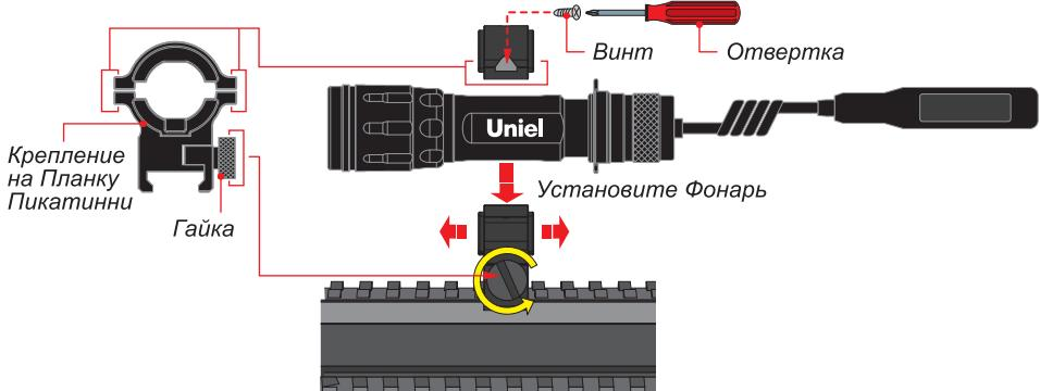
4.1. Открутить два винта на креплении (прилагаемой отверткой).
