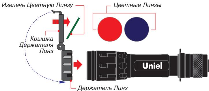
3.1. Установите световой фильтр на головную часть фонаря до характерного щелчка.
