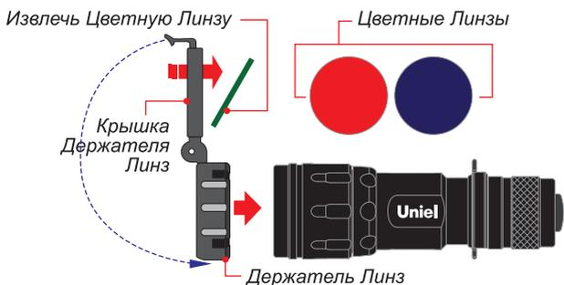
3.1. Установите световой фильтр на головную часть фонаря до характерного щелчка.
