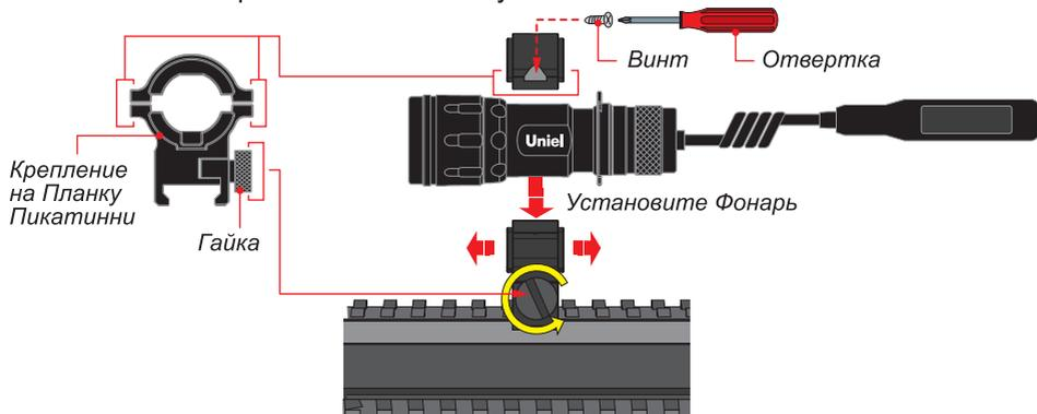
4.1. Открутить два винта на креплении ( прилагаемой отверткой).
