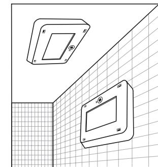
1. Просверлить в стене/потолке отверстия диаметром 8 мм.
