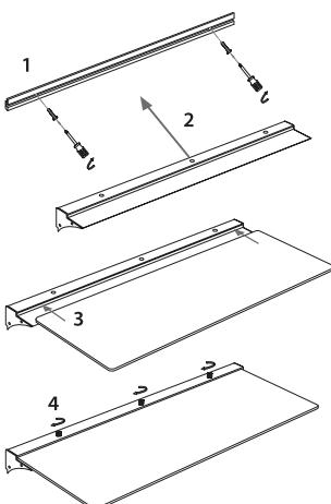
1. Зафиксируйте крепежную планку на монтируемой поверхности.
