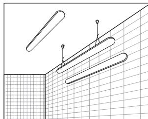
Накладные светодиодные линейные светильники устанавливаются на любую ровную поверхность. Подвесные – крепятся к потолку при помощи специальных тросов, изготовленных из нержавеющей стали. Длина троса – 1,5м.
