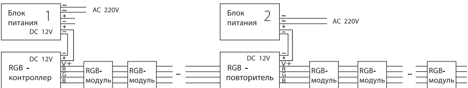
Схема 2. Последовательное подключение. Блоки питания 2шт или более.
