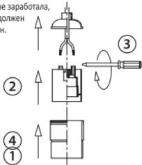
1. Снимите верхнюю часть патрона (крышку), потянув ее вверх.
