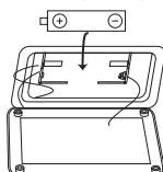
рейного блока, извлеките старый аккумулятор и вставьте новый, строго соблюдая полярность. Затем верните крышку на место иочно закрепите винтами.
