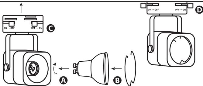
3. Вставьте лампу соответствующей мощности в патрон светильника. Максимальная мощность лампы указана на упаковке светильника. **A**
