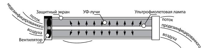
Рециркулятор является облучателем закрытого типа, в котором бактерицидный поток от ультрафиолетовой лампы распределяется в небольшом замкнутом пространстве. В зоне облучения применены материалы, обладающие высокими отражающими свойствами, обеспечивающие эффективную бактерицидную обработку воздушного потока (отражающая способность УФ-излучения не менее 75 %).
