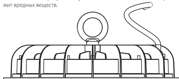
**! Запрещается использовать светильник в цепях с тиристорными регуляторами напряжения (диммерами).**
