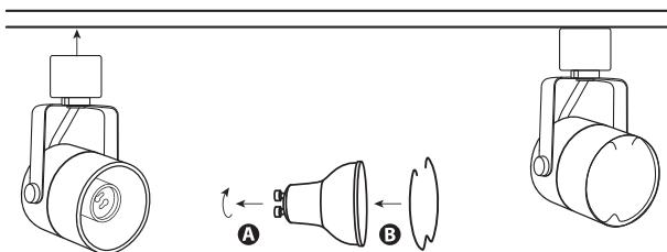
3. Вставьте лампу соответствующей мощности в патрон светильника. Максимальная мощность лампы указана на упаковке светильника. Зафиксируйте ее с помощью фиксирующей пружины. **Внимание!** Адаптер светильника предназначен для использования с однофазным шинопроводом. При использовании шинопровода другого типа замените комплектный адаптер на совместимый с выбранным вами шинопроводом (адаптер приобретается отдельно).
