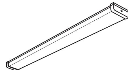
**Внимание!** Защитный проводник (желто-зеленого цвета) присоединяется только к проводу желто-зеленого цвета. Подключение производится согласно Правилам устройства электроустановок СО 153-34.20.120-2003. Подключение светильника к сети переменного тока 220 В осуществляется с помощью трехпроводного кабеля: провод коричневый – L (фаза), синий – N (нейтраль), желто-зеленый – E (заземление). Фазный провод должен быть подключен через автомат защиты сети, имеющий время срабатывания не более 0,1 с.
