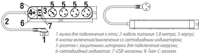
1-вилка для подключения к сети; 2-кабель питания 1,8 метра; 3-корпус;
