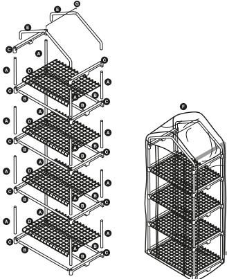
2. Собирайте парник на сухой ровной поверхности. Во время сборки следите, чтобы каждая трубка была плотно зафиксирована в пазе скобы.
