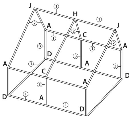
2. Собирайте парник на сухой ровной поверхности. Во время сборки следите, чтобы каждая трубка была плотно зафиксирована в пазе коннектора.
