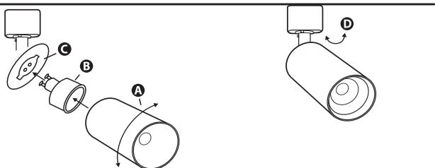
3. Снимите корпус светильника, вращая его против часовой стрелки **A**. Вставьте лампу соответствующей мощности с цоколем GU10 в патрон **C** и поверните ее по часовой стрелке до упора **B**. Наденьте корпус поверх лампы и зафиксируйте его на основании, повернув по часовой стрелке.
