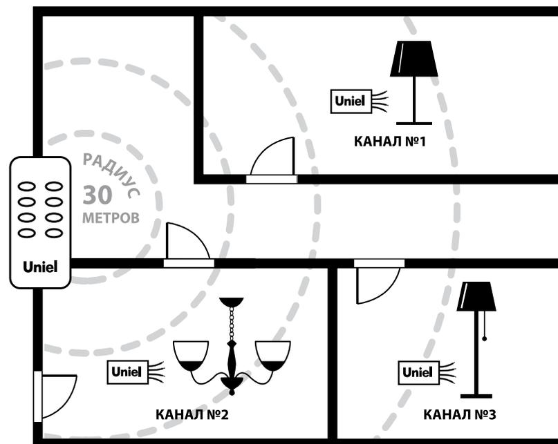
Пульт дистанционного управления световыми приборами с тремя **независимыми** друг от друга приемными устройствами.
