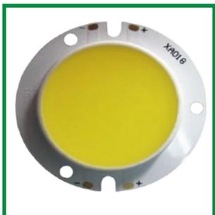
Светодиодный модуль изготовлен по технологии COB.
