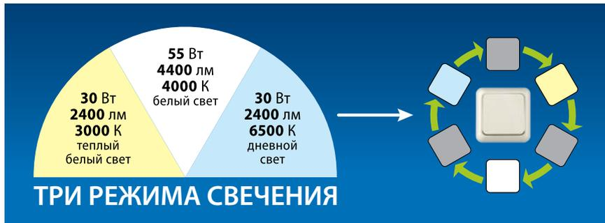
При установке нескольких светильников в одном помещении необходимо подключать все светильники к одному настенному выключателю света для одновременного переключения всех светильников в один режим.
